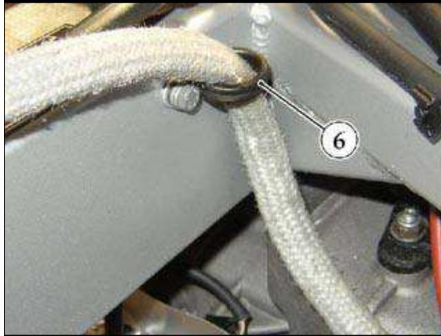
紧固将离合器分配器模块连接至变速箱 (仅对于带 F1 变速箱的车款) 的管的支架 (6)。
