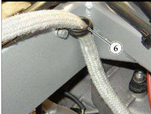
● 断开将离合器分配器模块连接至变速箱（仅对于带F1变速箱的车款）的管的支架(6)。
