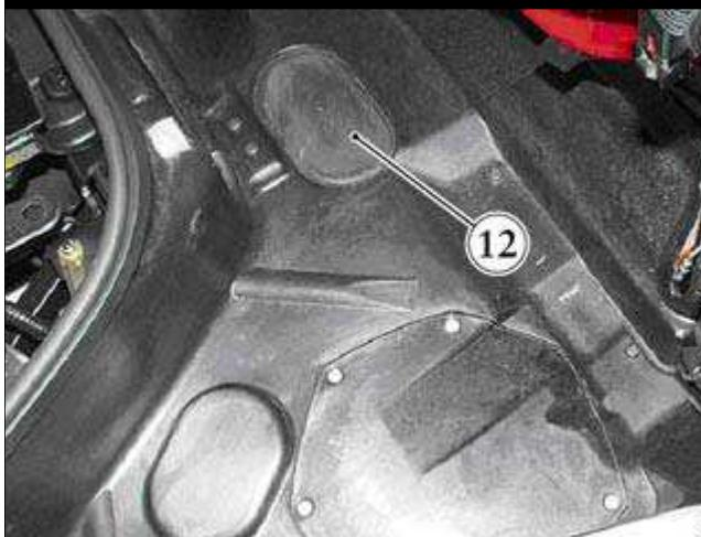
● 从折叠车顶机架内, 将橡胶衬垫(12)安装到前部副支架紧固螺钉。
