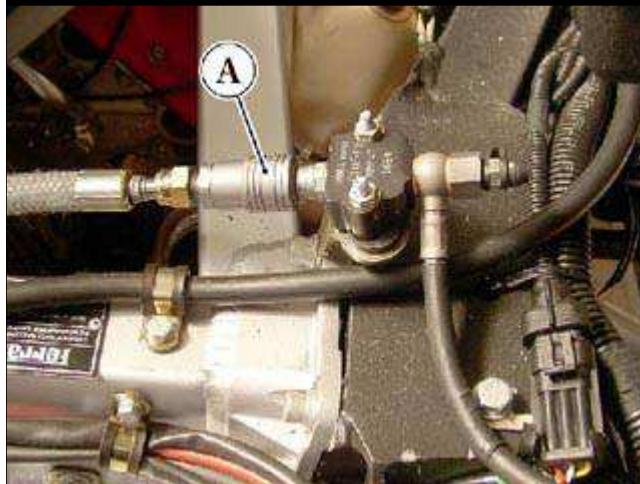
● 从离合器分配器模块断开变速箱壳体连接管上的快速管接头(A)（仅对于带F1变速箱的车款）。
