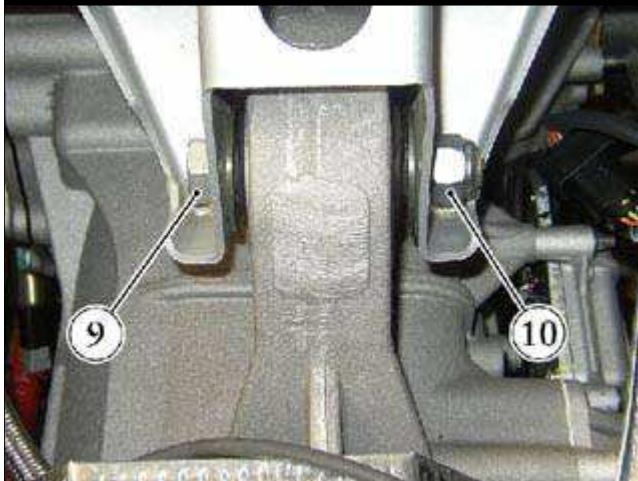
● 拧下并拆卸将变速箱紧固至可移动副框架的螺钉(9)及螺母(10)。
